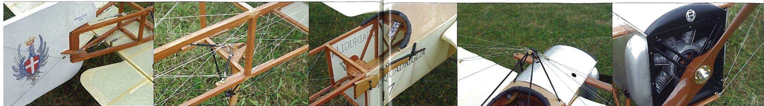
Unglaublich, aber es geht. Das Staffelfabzeichen ist ein Foto, mit einem Tintenstrahldrucker direkt auf das Bespannmateriale (Oratex) gedruckt • Der in einer Kulissee geführte Sporn ist in Längsrichtung mit Gummiseilen gefedert. Dieses Bild verdeutlicht die Bezeichnung „Drahtkommode“ in anschaulicher Weise • Der Beobachter hat in seinem Cockpit für die Navigation eine Art frühes Roadbook zur Verfügung.
