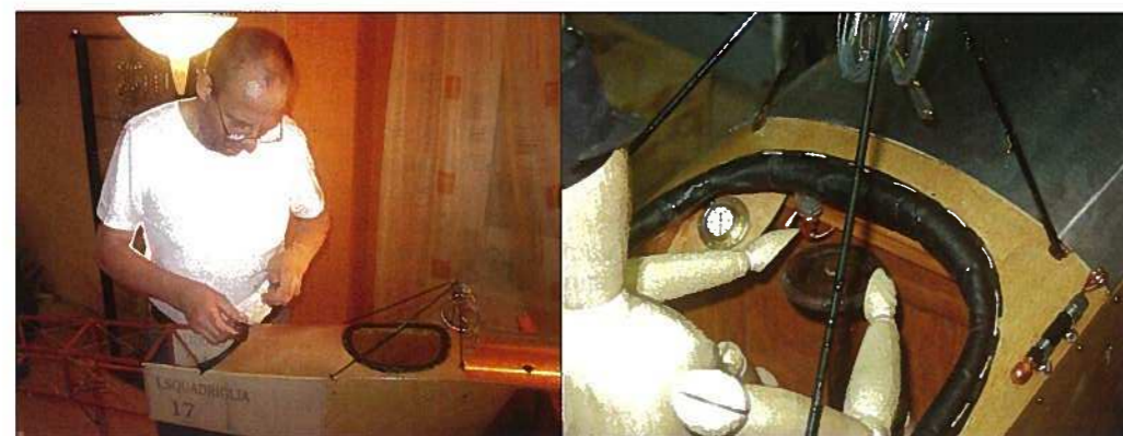
Die gepolsterten Ledereinfassungen der Cockpits sind wie im Original angenäht • Der Cockpitausbau hält sich in Grenzen. Der Pilot sieht einen Drehzahlmesser, ein Benzinschauglas und die »Blériot«-typische Steuersäule mit Lenkrad. Außen ist noch eine Art handbediente Luftpumpe angebracht, mit der er während des Flugs den Benzindruck im Tank erzeugen musste
